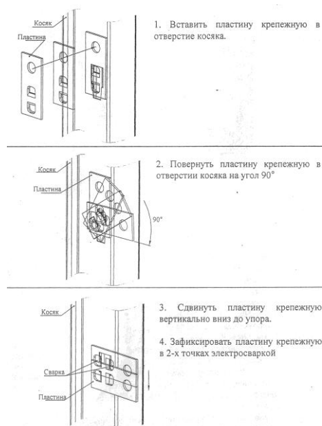
Схема установки пластин крепежных
